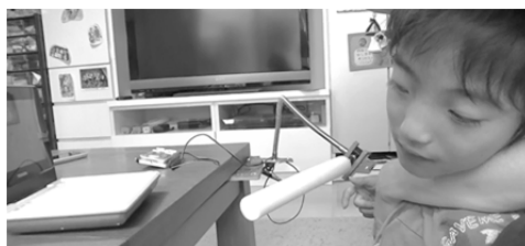
自宅で棒型のスイッチと改造リモコンを使ってDVDプレーヤーを操作する取組
