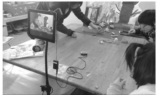
タップ操作を代替できる外部スイッチと端末を固定するアームを取り入れながらストップモーションアニメを作成する。
